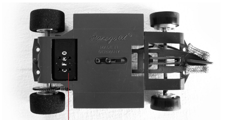
Einbaulage des Motors. Die Typenbezeichnung muß an der Unterseite sichtbar sein!
